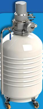
دستگاه تولید نیتروژن مایع، دستگاهی تمام اتوماتیک برای تولید نیتروژن مایع برای مصارف کم (25 لیتر در روز) می‌باشد. دستگاه ابتدا نیتروژن را از هوا فشرده (که به وسیله کمپرسور هوا تولید می‌شود) جداسازی می‌کند سپس گاز نیتروژن وارد مخزن شده و تبدیل به مایع می‌شود.
